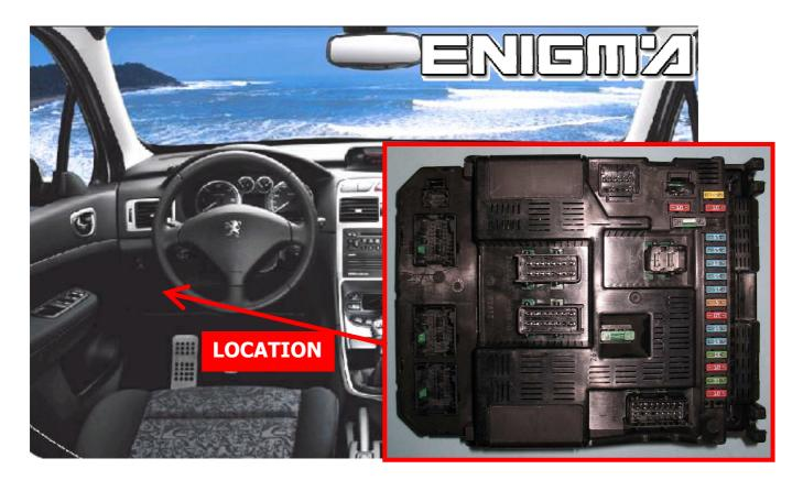
USE CABLE C12, TAKE OFF BACK SIDE FROM BSI, THEN CONNECT OR SOLDER CABLE LEADS ACCORDING TO PIN AS SHOWN OF BELOW PHOTO:
